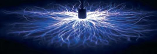
Essai diélectrique sur tapis isolant
